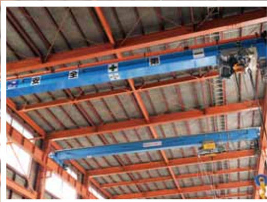
▲天井クレーンは元々1基だったが、作業効果改善のため2基に増設。菅原社長による、社内の声を実現した一つの例
