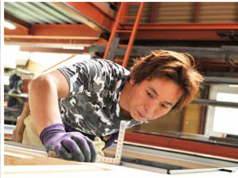
▲正確なデータを収集するため、試験体の製作は釘の間隔など非常に細かく指示されている
